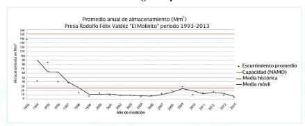
Por otra parte, este cambio en el manejo de la presa también obedece a cambios de origen físico. Como se observa, después de 1996 el escurrimiento que fluye hacía la presa El Molinito disminuyó drásticamente.
